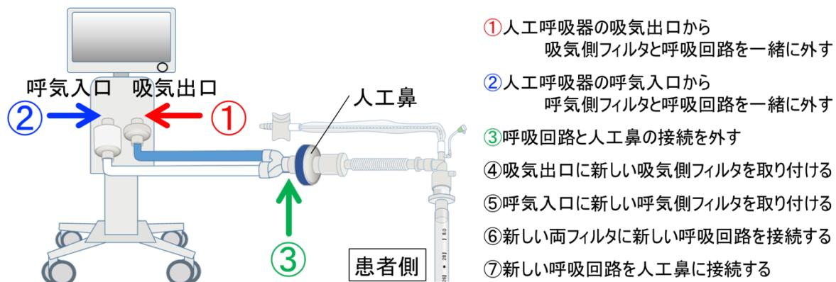
図3 呼気側フィルタの交換手順 (参考)
